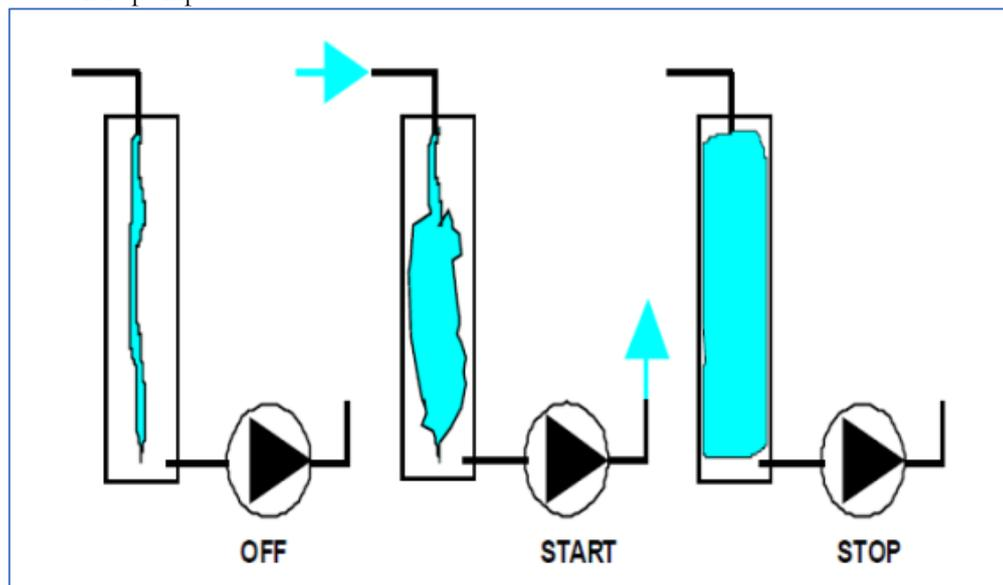
Figura 3: schema di funzionamento della pompa a polmone
